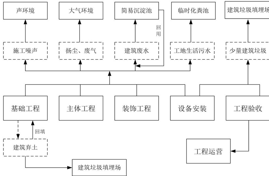
图2 污水处理厂施工工艺流程图及产污环节图
