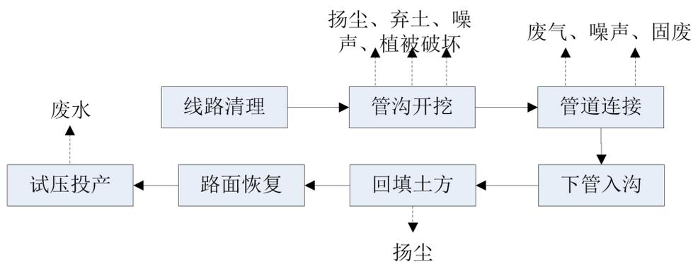
图3 管道大开挖施工工艺流程及产污环节图
