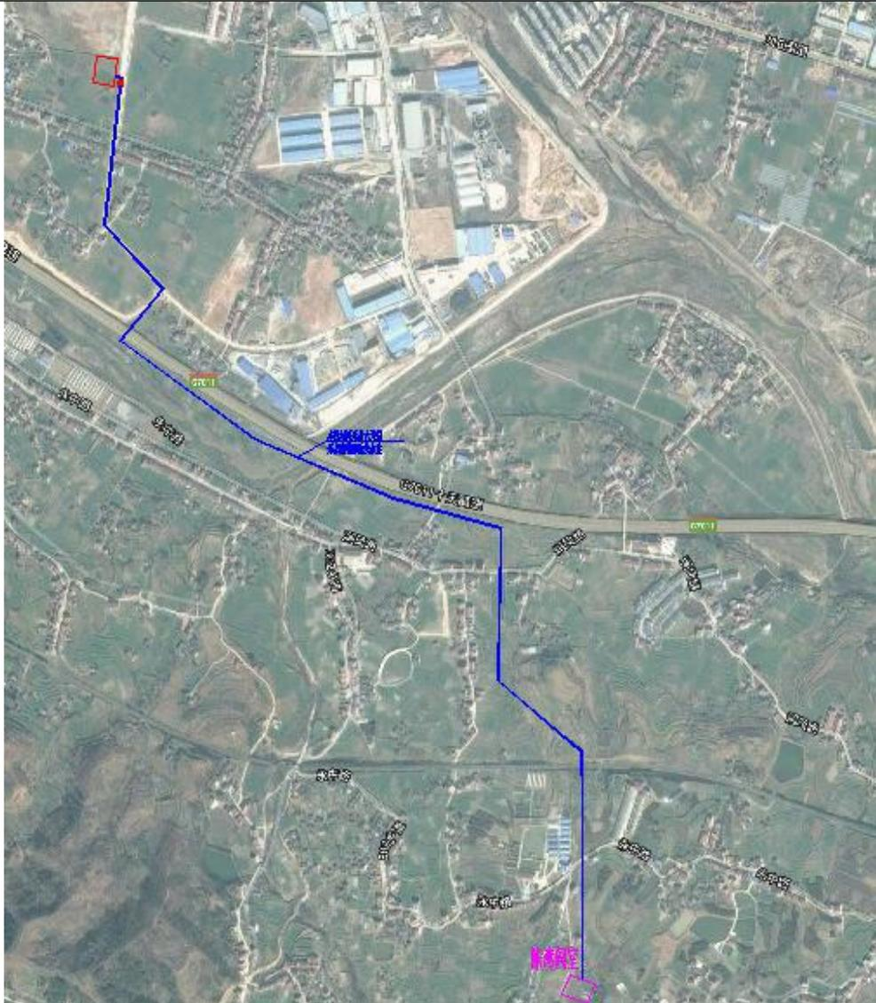
图2 高压管网走向示意图（方案二）
