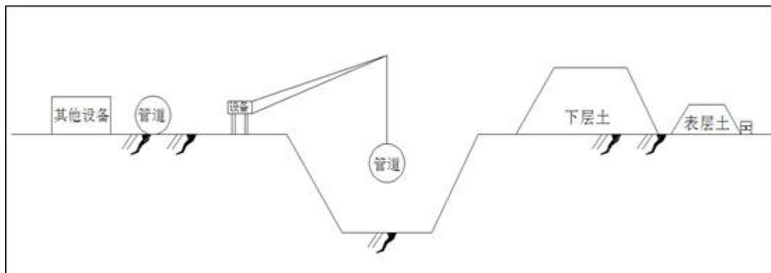
图 4 开挖方式施工示意图
