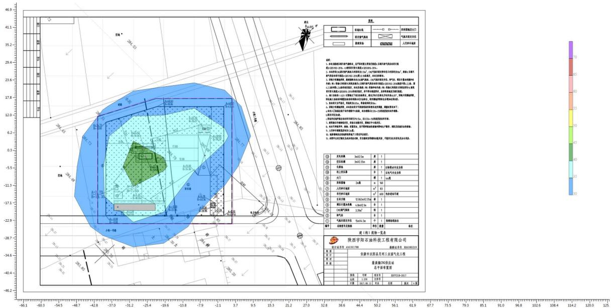
图 11 近期蒲溪镇 CNG 供应站噪声预测结果图
