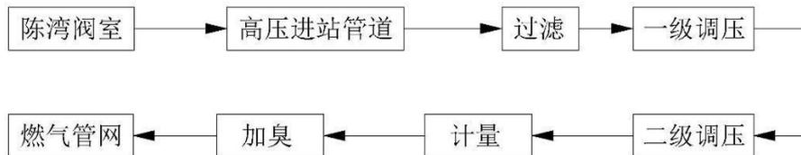
图10 天然气门站工艺流程及产污环节图
