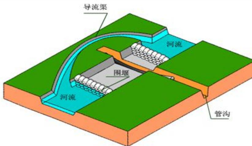
图5 河流穿越施工工艺示意图
