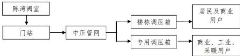
图9 工艺流程及产污环节图
