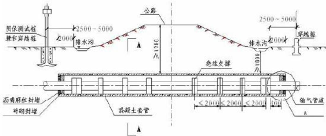
图 6 穿越顶管施工工艺示意图
