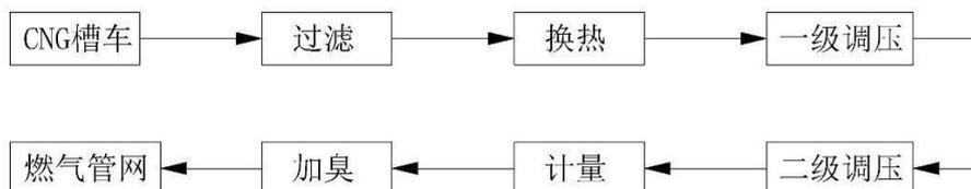
图 8 CNG 供应站工艺流程及产污环节图
